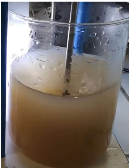
Figura 24. Se muestra el agua a tratar mezclada con los biopolímeros. Figure 24. Wastewater to be treated mixed with the biopolymers is shown.
