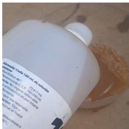
Figura 9. Vertido de alcohol etílico al extracto líquido de pectina.
