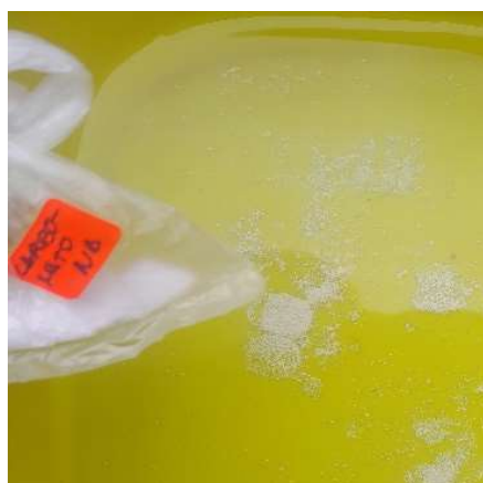
Figura 17. Vertido de Carbonato de sodio para la desproteinización. Figure 17. Addition of sodium carbonate for deproteinization.
