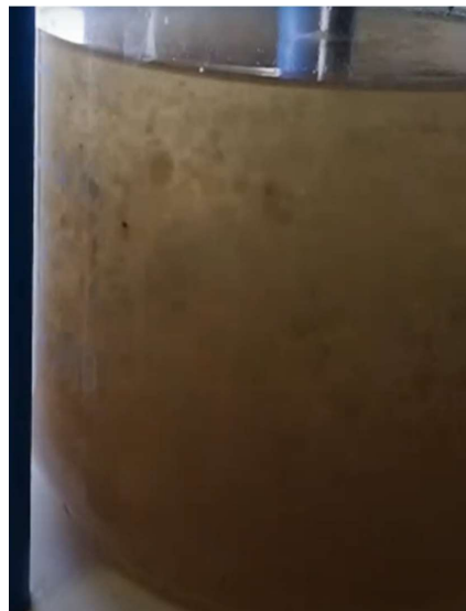
Figura 25. La suspensión se agita en un agitador mecánico. Figure 25. The suspension is stirred using a mechanical stirrer.
