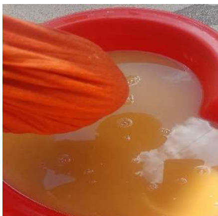
Figura 8. Proceso de filtración para eliminar las fibras de cáscaras.
