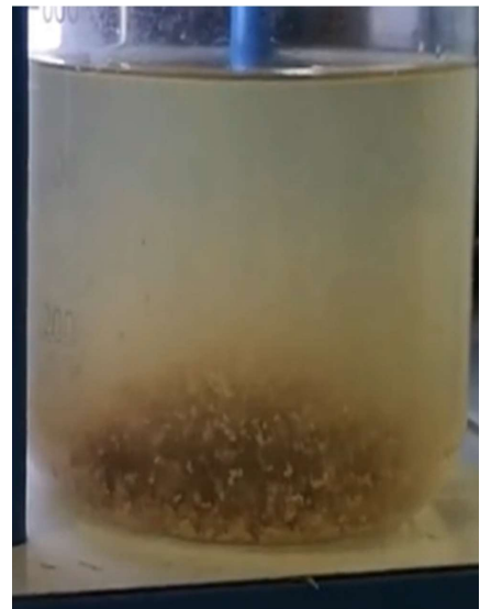
Figura 26. Se deja en reposo para observar la formación los flóculos. Figure 26. The suspension is left to stand to observe floc formation.
