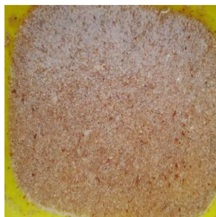
Figura 18. Reposo del carbonato de sodio con el exoesqueleto. Figure 18. Resting period of sodium carbonate with the exoskeleton.
