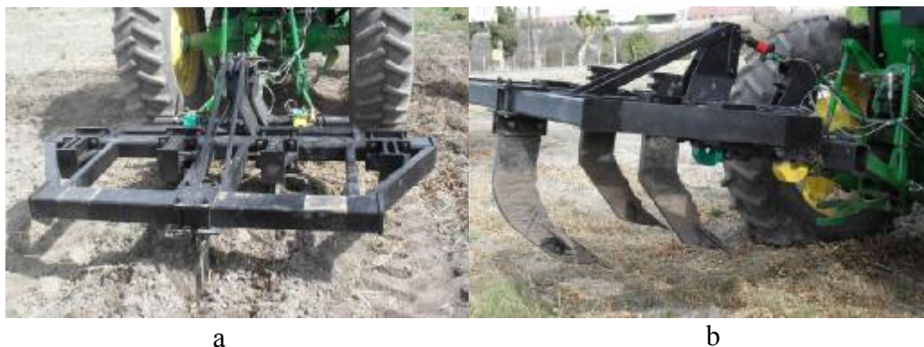
Figura 2. Equipo construido para la determinación de la demanda de energía con diferentes arreglos de cincelos. (a) Sensor integral. (b) Arreglo del tratamiento seis con cincel trasero con alas y cincelos frontales ajustados a 0.30 m de profundidad.
