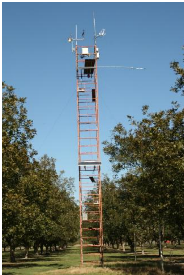
Figura. 1. Sistema de covarianza de remolinos sobre el dosel de un cultivo de nogal pecanero para medir el flujo de calor, vapor de agua y CO_2 .
