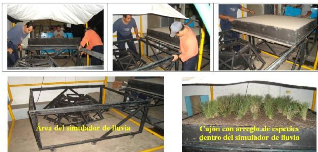
Figura 7. Transporte y montaje del cajón de medición en el simulador de lluvias.
