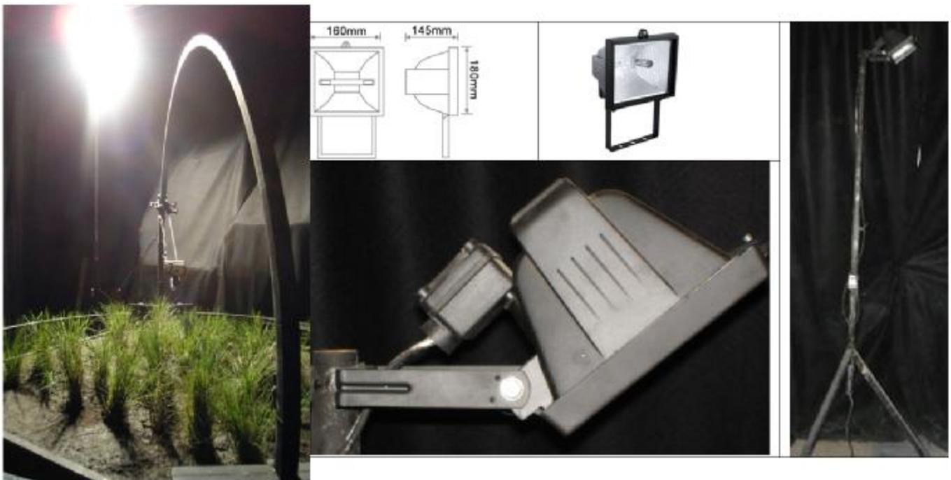
Figura 6. Sistema de iluminación utilizado para el experimento de laboratorio del SIGO-CP.
