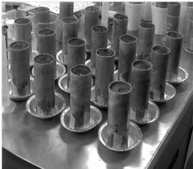
Figura 1. Unidades experimentales representadas por cada cilindro de aluminio de 15 cm de altura y 5 cm de diámetro.
