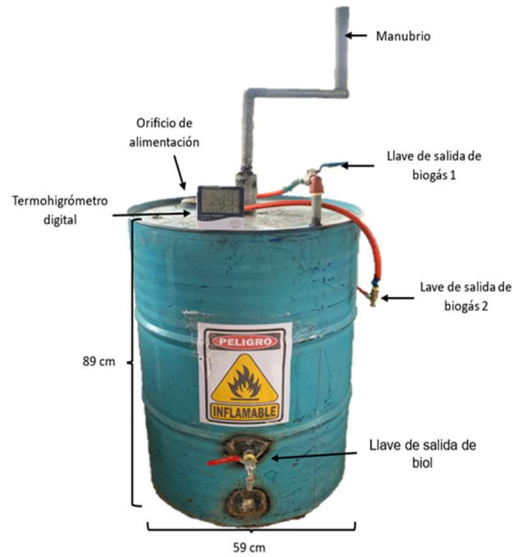
Figura 3. Biodigestor a escala piloto. Figure 3. Pilot-scale biodigester.
