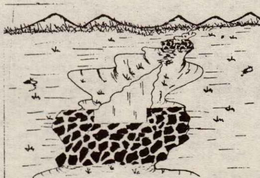
FIGURA No. 1.- Principales estructuras para el control de azolves en cárcavas, de tipo "permanente"; (a) Presa filtrante de piedra acomodada, (b) Presa filtrante de gaviones y (c) Presa de mampostería
