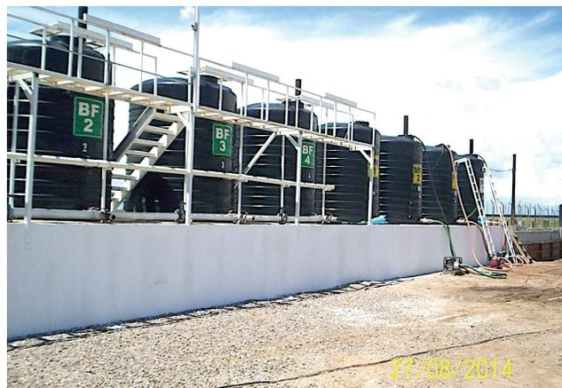
**Figura 4. Biorreactores para la elaboración de biofertilizantes.**
